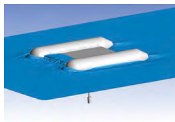
■ FSI du capteur flotteur comme réponse transitoire au flux de courant
