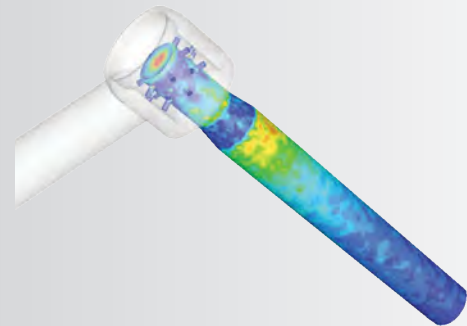
L'image montre les contours de la vitesse d'érosion sur une vanne d'étranglement.
