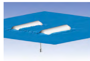
■ Le capteur flotteur est abaissé en raison de l'écoulement sur le capteur en dessous du flotteur, pont inondé.
